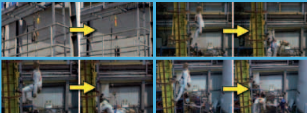
El fabricante de líneas de vida Latchways ha realizado y superado satisfactoriamente los ensayos realizados con maniqués antropomórficos.
