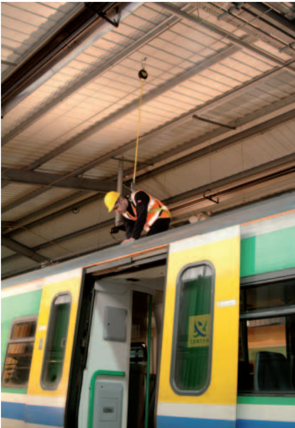
Cada vez son más los trabajos que se protegen con sistemas anticaídas, como el mantenimiento de trenes y autobuses.
