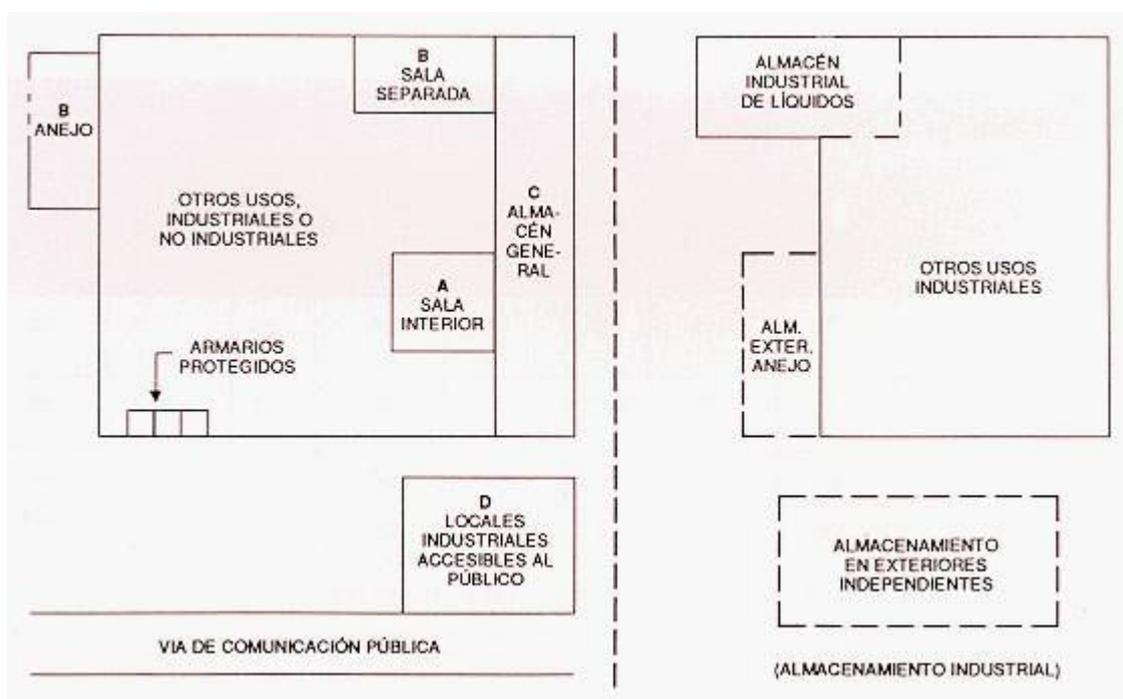
**Fig. 1: Ejemplos de las disposiciones posibles de almacenamientos de recipientes móviles Armarios protegidos**
