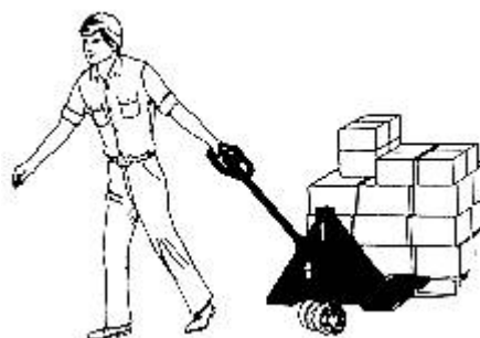
Fig. 8: Tracción en posición de trabajo<
