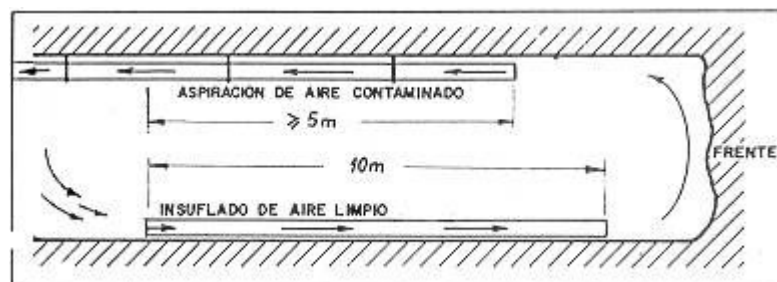
Fig. 16: Sistema de ventilación mixto en galerías subterráneas
