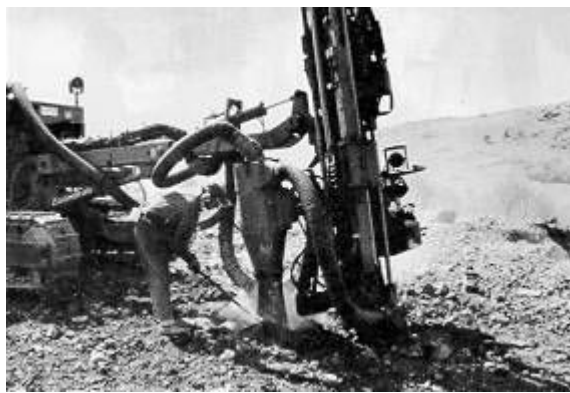
Fig. 6: Conducto flexible adaptable a la movilidad del equipo
