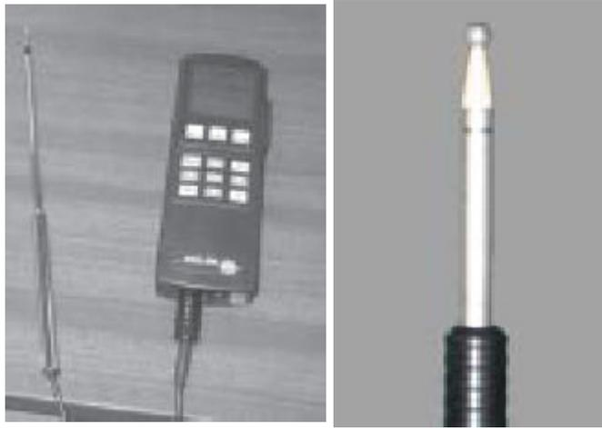
Los primeros están integrados por dos sensores másicos de caudal de convección térmica; uno de ellos está caliente y el otro a temperatura ambiente. La diferencia de temperatura (medida como voltaje o intensidad de corriente) es una magnitud directamente proporcional a la velocidad (y caudal) del fluido.
