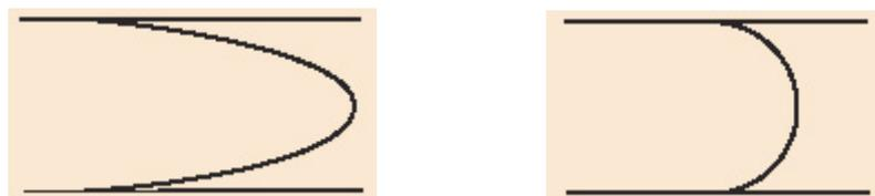
Perfil de velocidades en un conducto en flujo laminar (a) y en flujo turbulento (b)
