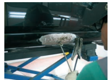
Reparación del estribo con martillo de inercia
