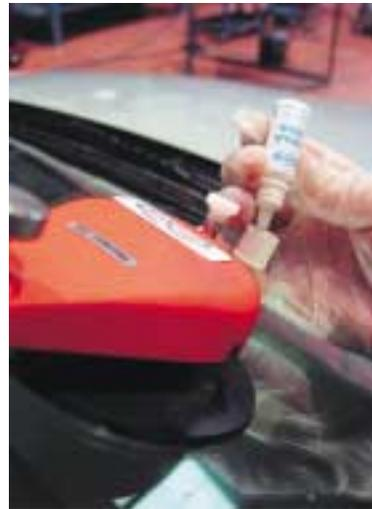
Aplicación de resina en el inyector
