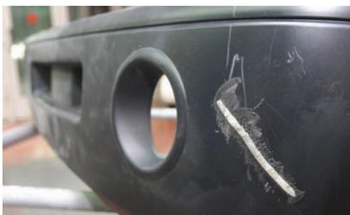
Soldadura en termoplástico
