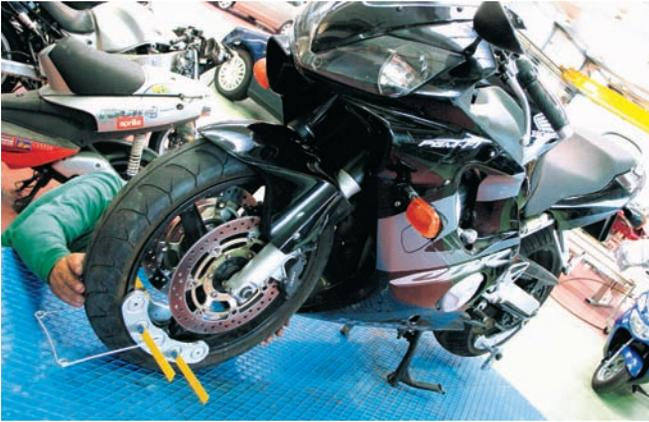
→ El principio de funcionamiento del medidor Profi-Bat láser, de Ryme, parte de la base de que, para asegurar una medición correcta, la rueda trasera ha de estar perfectamente alineada.
