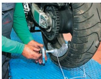
Fijación de los cabezales del láser
