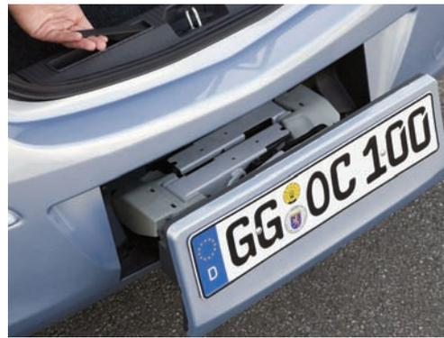
Desbloqueo y extracción del dispositivo Flex-fix
