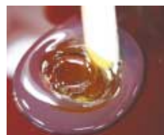
Mezcla manual del adhesivo
