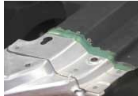
Acabado final de una unión con adhesivo sobre aluminio
