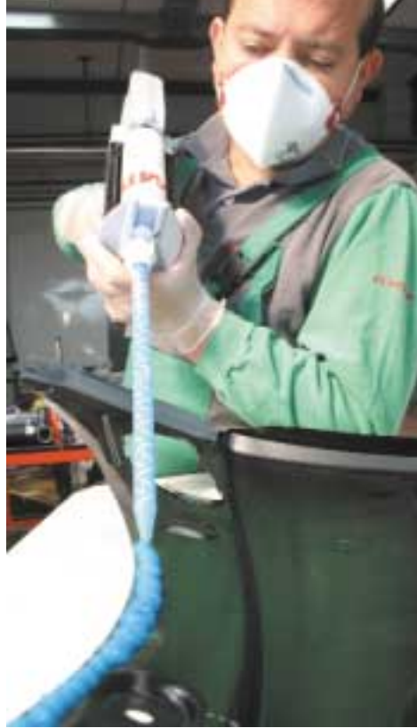
Aplicación del adhesivo con pistola
