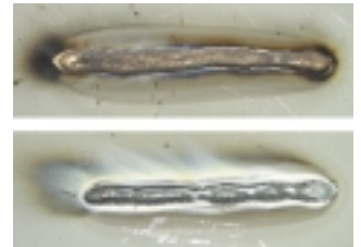
Soldadura normal en una chapa galvanizada y soldadura MIG-Brazing
