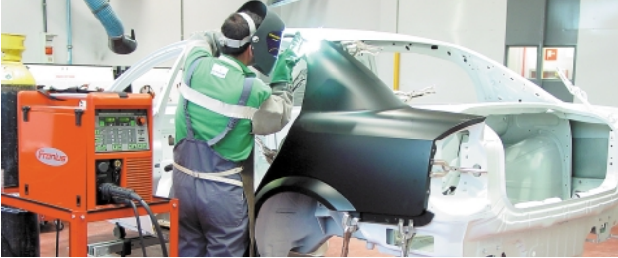
Soldadura MIG-Brazing en una aleta
