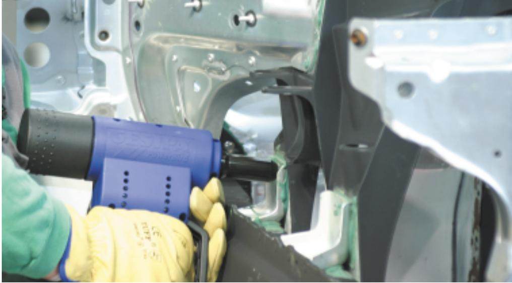
Unión mediante remachado y pegado
