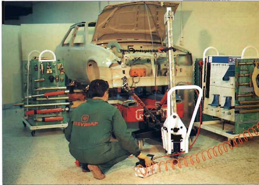
Bancada Celette trabajando con el sistema MZ.
