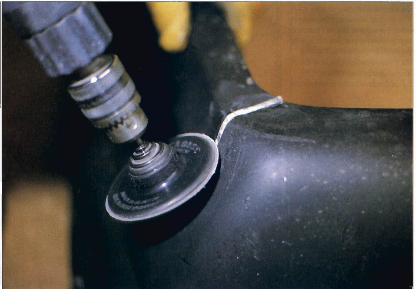
Lijado de la soldadura.
