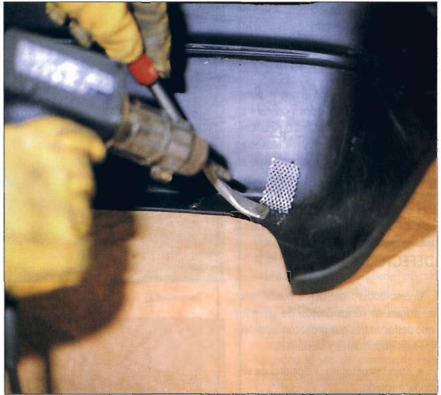
Reforzando con malla metálica.
