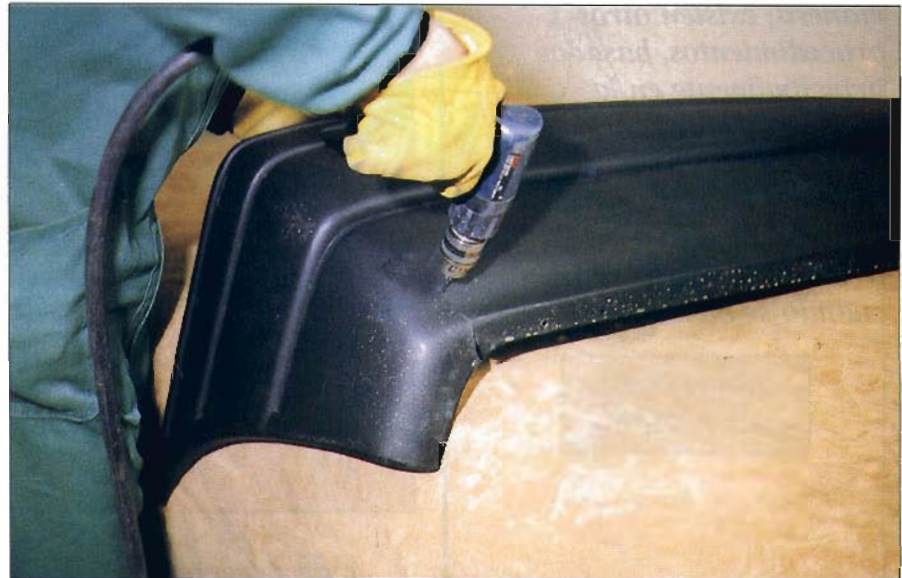
Practicando un taladro al final de la fisura.
