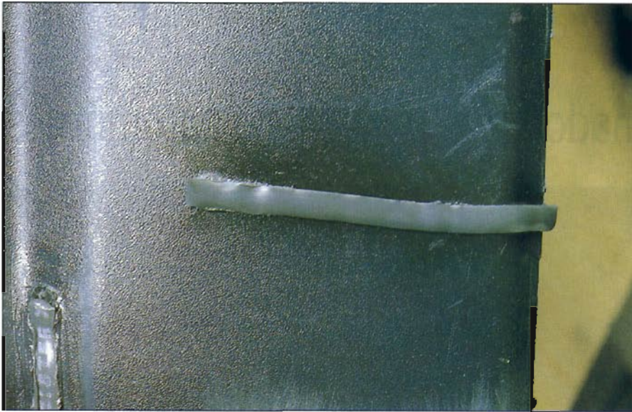
Soldadura realizada con baja temperatura.
