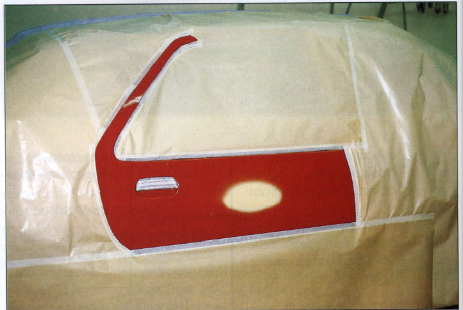
Preparación para realizar un parche difuminado.
