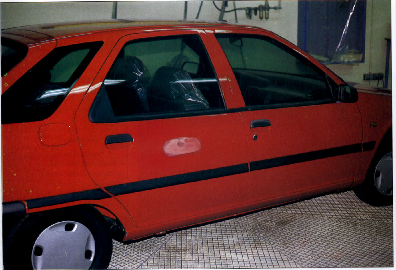
Zona dañada a reparar mediante técnica de difuminado.
