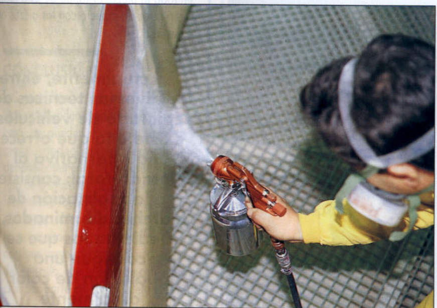
Movimiento de la pistola para la realización del difuminado.
