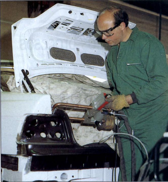
Protección del interior del vehículo con manta ignífuga.
