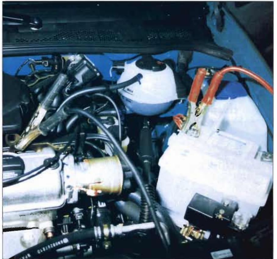
Forma de conectar una batería auxiliar para arrancar un vehículo.
