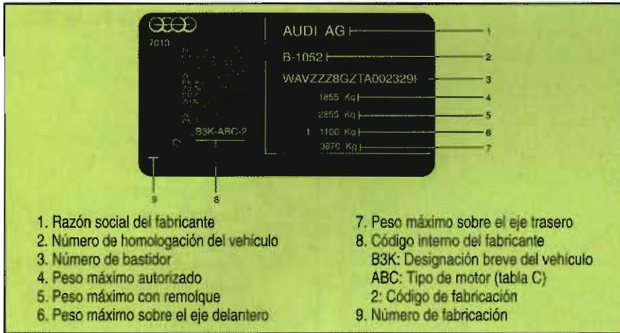
Figura 2. Placa del constructor
