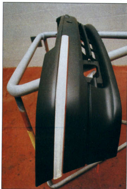
Pieza nueva no imprimada. La moldura está enmascarada.
