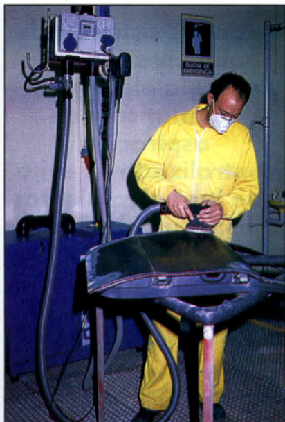
Conexión de una lijadora neumática.
