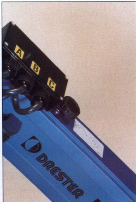
Sistema de movimiento de aire (entrada de aire comprimido, un regulador de caudal de aire de salida y conjunto de boquillas para la salida del aire).
