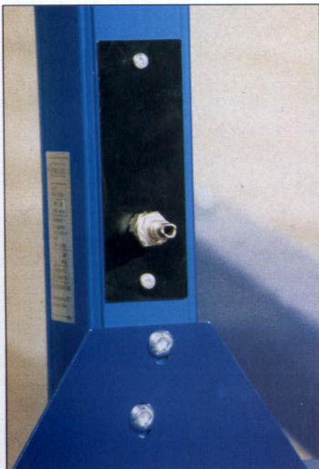
Sistema de movimiento de aire (entrada de aire comprimido, un regulador de caudal de aire de salida y conjunto de boquillas para la salida del aire).
