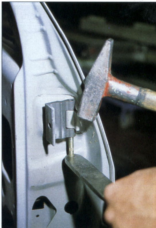
El desmontaje de cierto tipo de pasadores requiere el empleo de útiles específicos.
