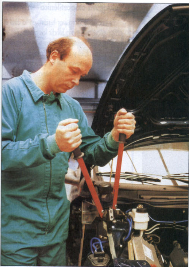
La colocación de remaches o tuercas autorremachables no reviste ninguna dificultad para el chapista.
