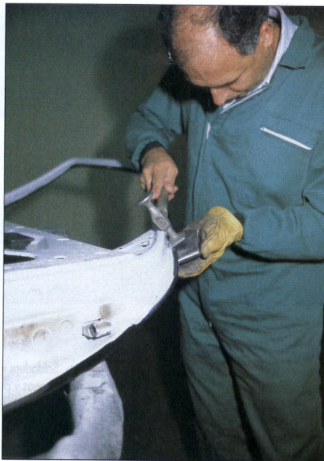
El plegado o engatillado es el sistema de unión característico en los paños de puerta.
