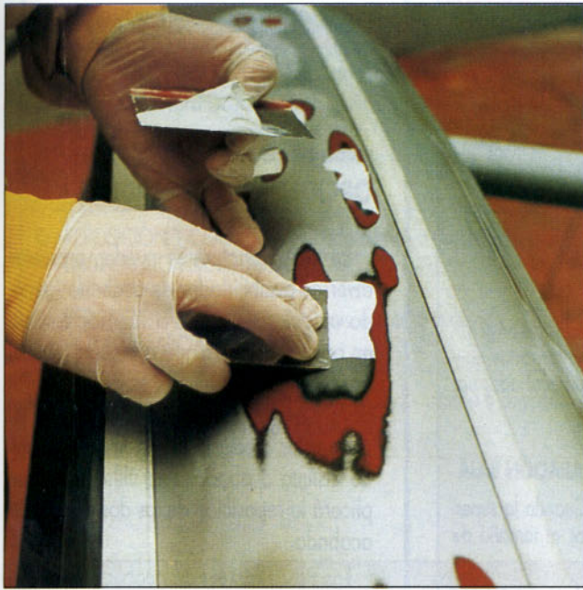
Aplicación y lijado de masilla en un paragolpes reparado
