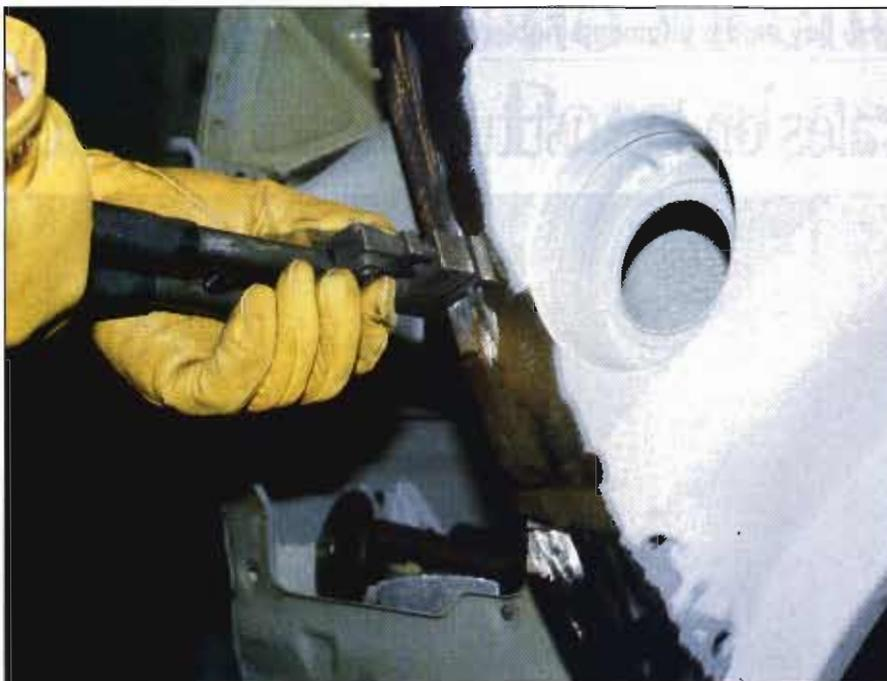
Escalonado de la junta para la aplicación de adhesivos.
