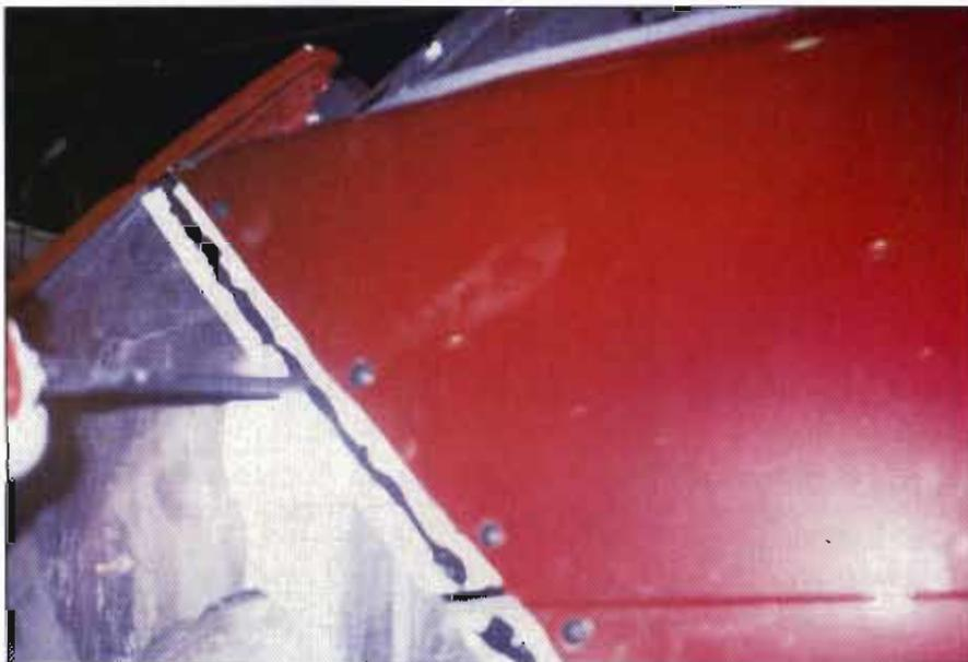
Aplicación de adhesivos en la sustitución de paneles de poliéster.
