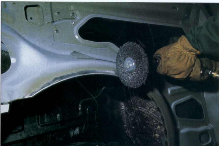
Eliminación de pintura.
