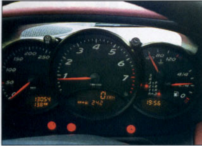
Detalle del cuadro de instrumentos, con los indicadores del Tiptronic a la derecha.
