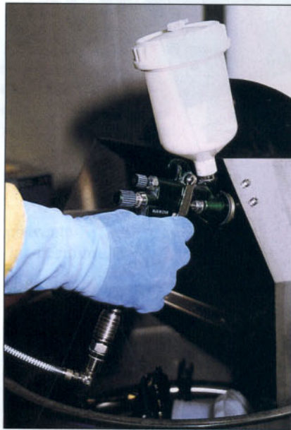
Atomización de la pistola a través de la boca de pulverización.
