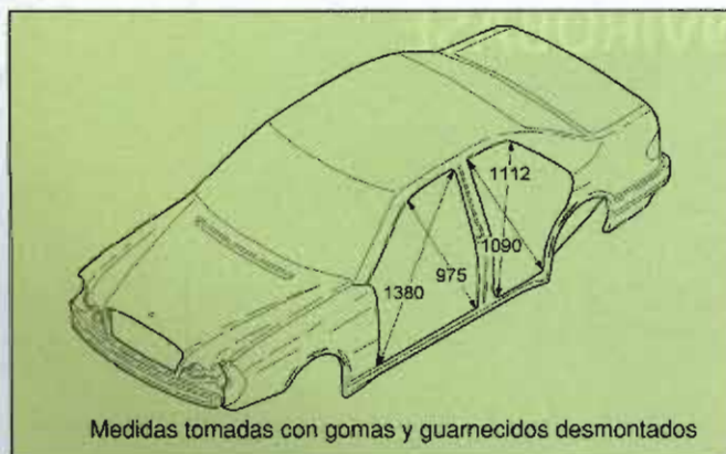
Figura 6. Medidas de los huecos de puerta
