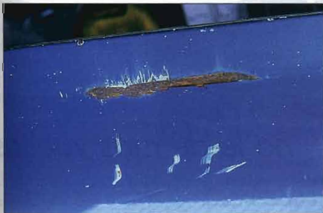
El revestimiento de zinc sigue siendo efectivo, incluso cuando el metal queda al descubierto.
