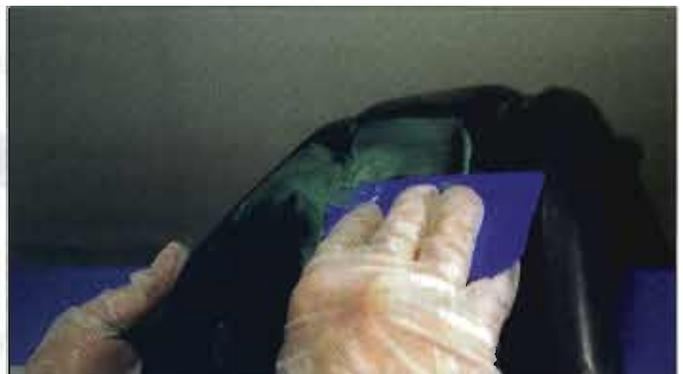
Modelado del adhesivo con lámina termoplástica por la parte interna y con espátula por la externa.
