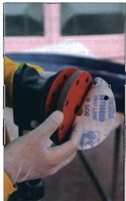
Colocación del abrasivo y disco interface
