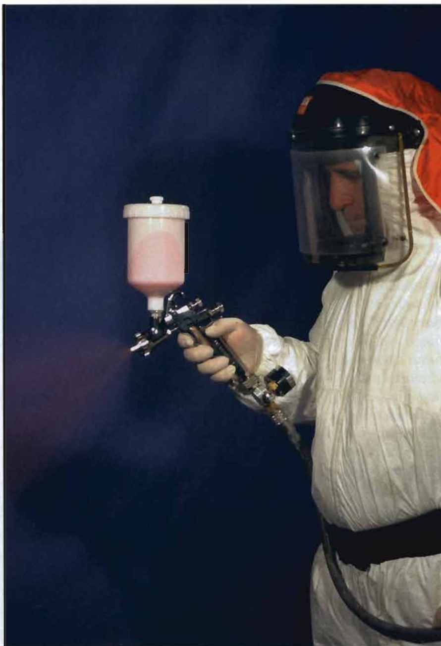
Durante la aplicación de pintura se producen emisiones VOC.
