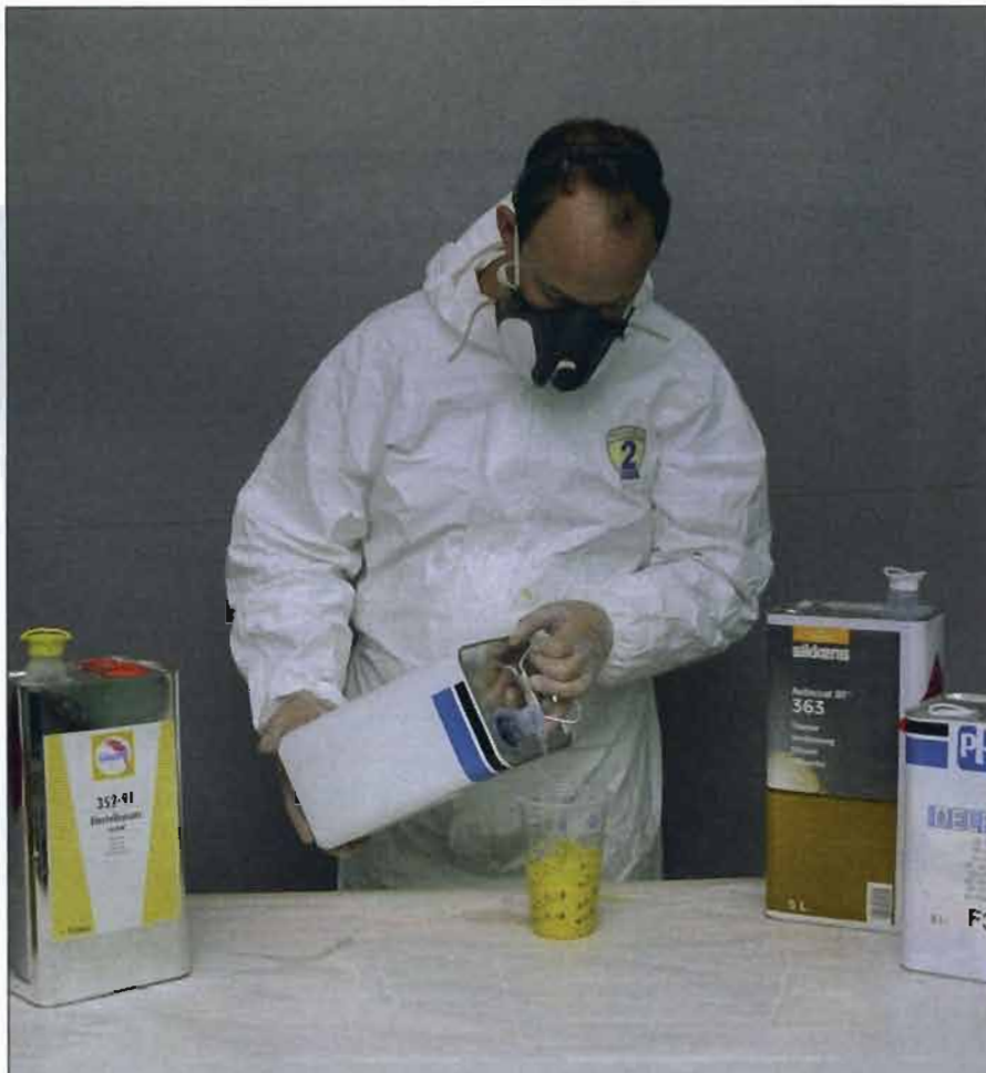
Los disolventes también se evaporan durante la preparación de mezclas.
