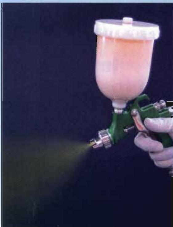
**La exigencia de alcanzar un coeficiente de transferencia superior al 65% asegura una mayor eficacia en la transmisión.**
