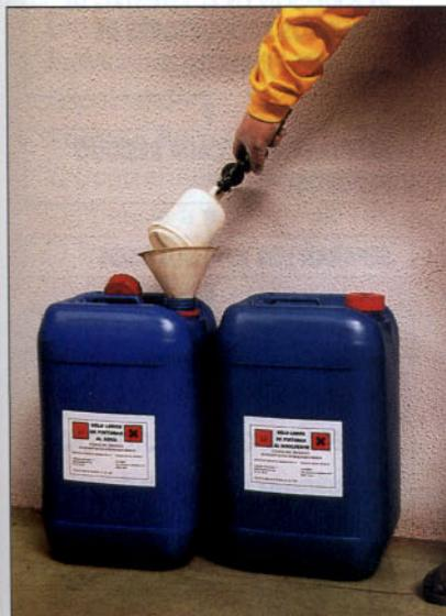
Separación de lodos de pintura base agua y base disolvente para su gestión diferenciada.
