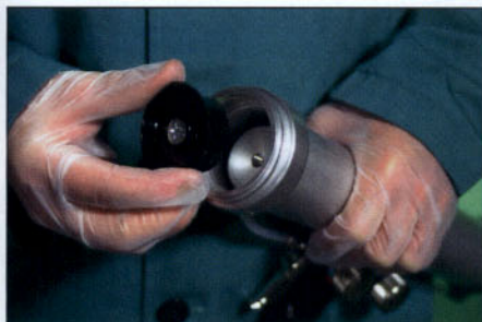
Preparación de la pistola para la aplicación de productos envasados en bolsas.
