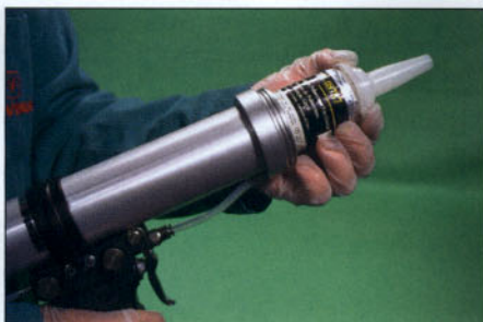
Preparación de la pistola para la aplicación de productos envasados en bolsas.
