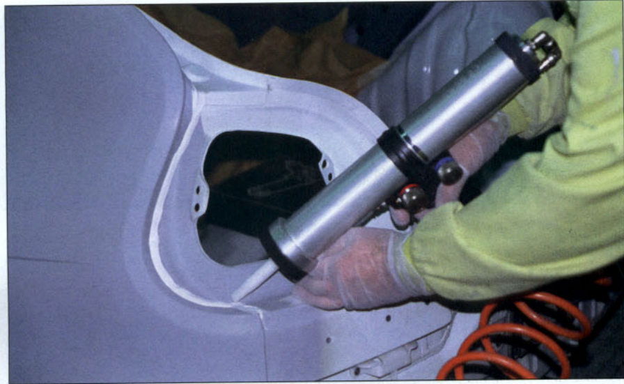
Sellado de juntas con cordón normal.
