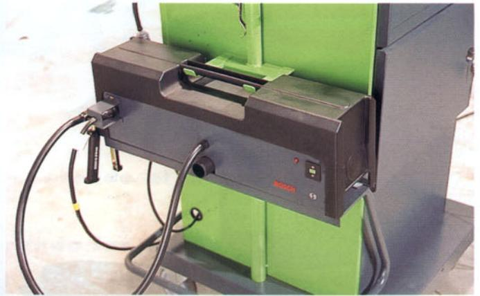
Módulo RTM 430 (opacímetro)
