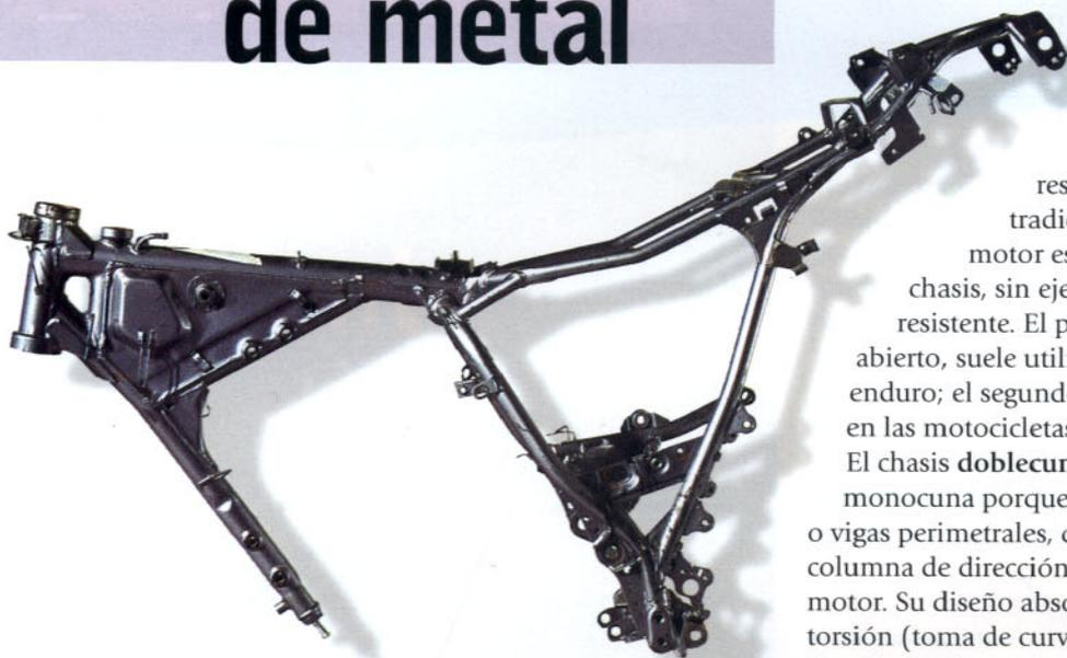
abierto, que utiliza el motor como elemento resistente, y cerrado, más tradicional, en el que el motor está dentro del propio chasis, sin ejercer una función resistente. El primero, monocuna abierto, suele utilizarse en motos de enduro; el segundo, monocuna cerrado, en las motocicletas *trail*.
