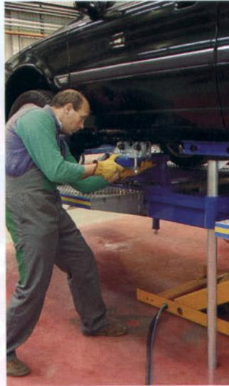
Acoplamiento del vehículo a la columna
