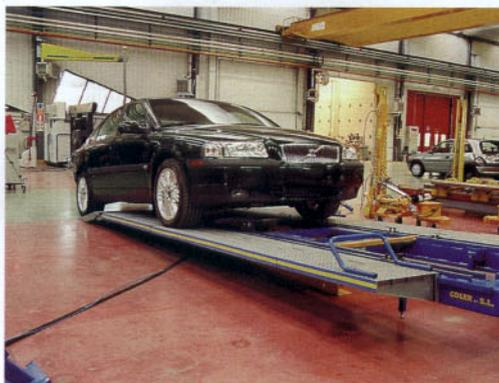
Montaje de las planchas de acero y subida del vehículo a la bancada
