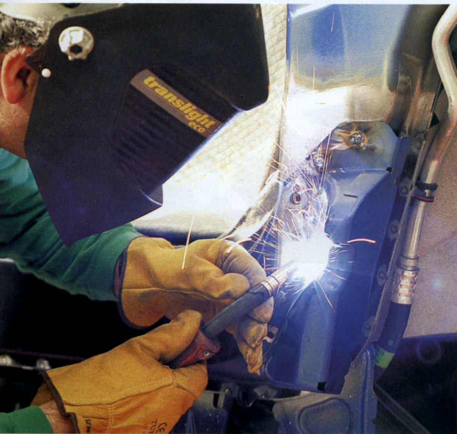
Soldadura del refuerzo anterior del estribo
