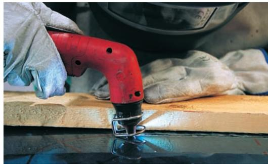
segundos, aproximadamente. Así se puede cortar en zonas pintadas, ya que se quema la pintura hasta conseguir el paso de corriente a través del metal.
