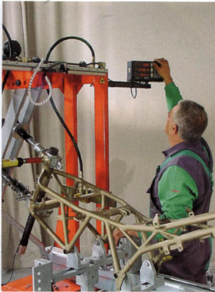
Medición de cotas en la bancada
