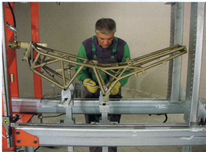
Anclaje del chasis a la bancada
