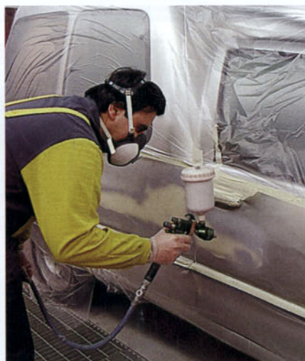
Aplicación de pinturas de fondo
