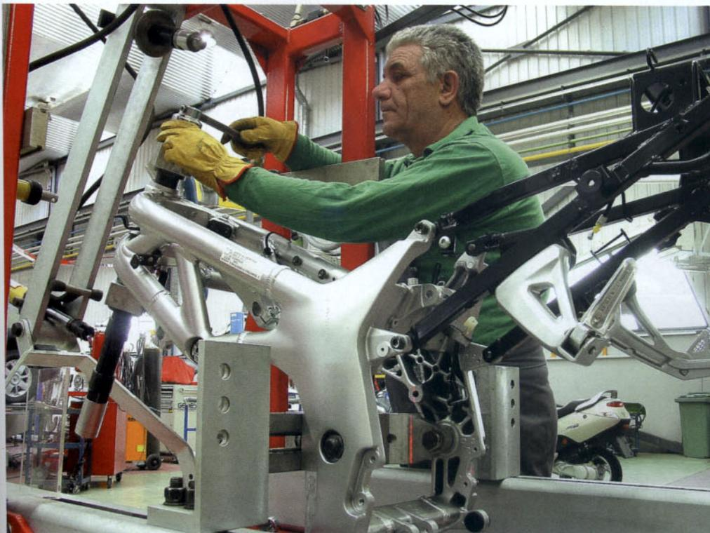
La utilización de aluminio para la estructura portante de la SV 650 S incide en la ligereza general del conjunto
