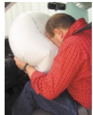
Secuencia de inflado de un airbag frontal
