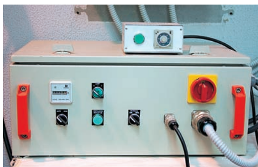
▶ Mandos de encendido de la lámpara UV
