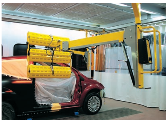
▶ Lámpara de secado por infrarrojos
