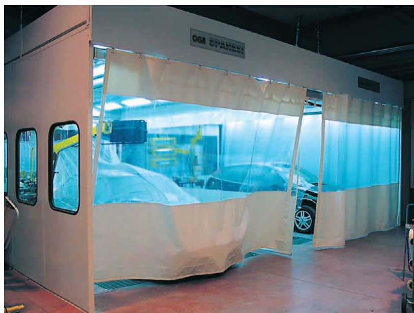
▶ Plano aspirante en funcionamiento
