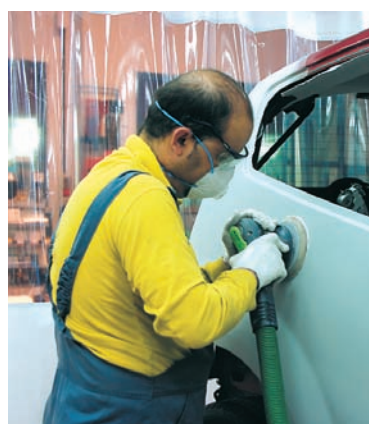
▶ Lijado en la zona de preparación
