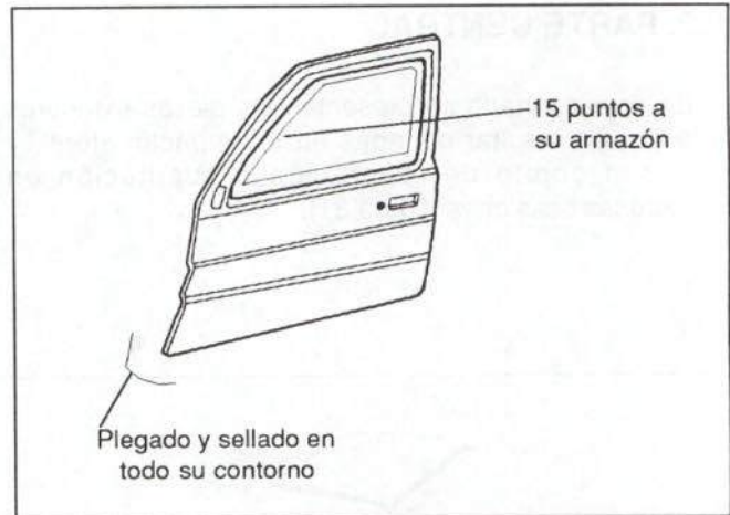
Figura 33.- Unión del panel
