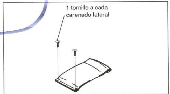
Figura 19.- Fijación de la tapa de unión de carenados
