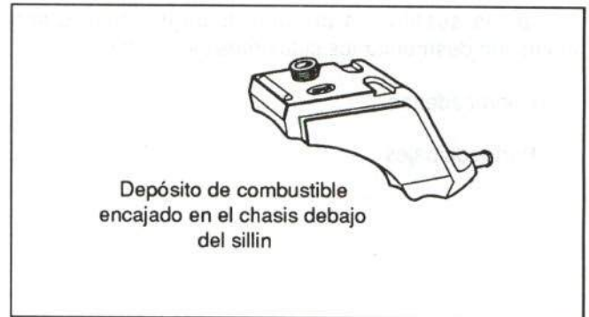
Figura 34.- Fijación del depósito de combustible
