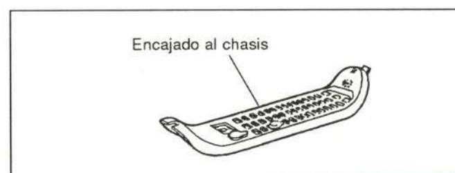
Figura 21.- Unión del adorno superior de chasis
