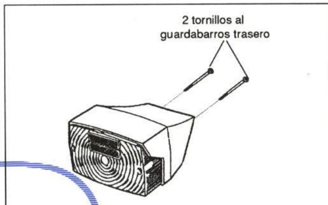
Figura 25.- Unión del piloto trasero
