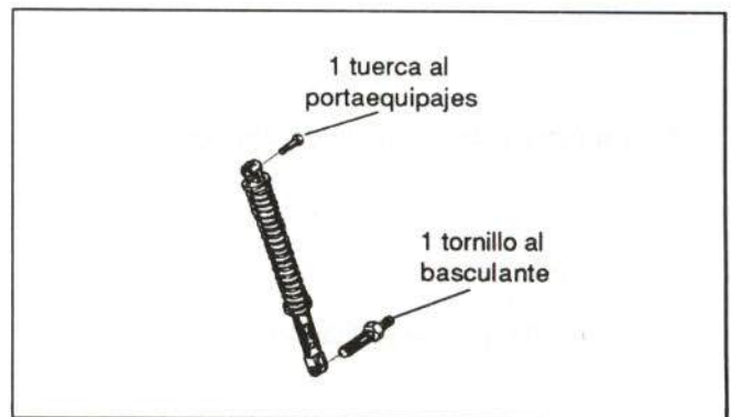
Figura 32.- Fijación del amortiguador trasero
