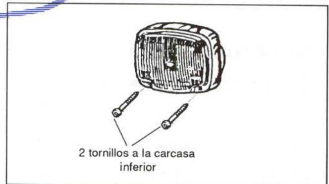
Figura 18.- Unión del faro delantero
