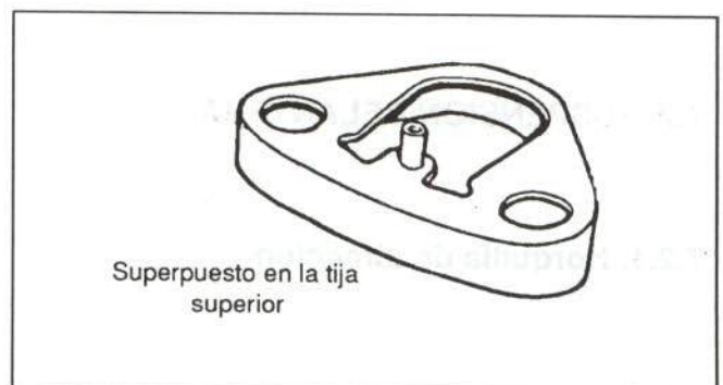
Figura 28.- Unión del suplemento de cubretija superior
