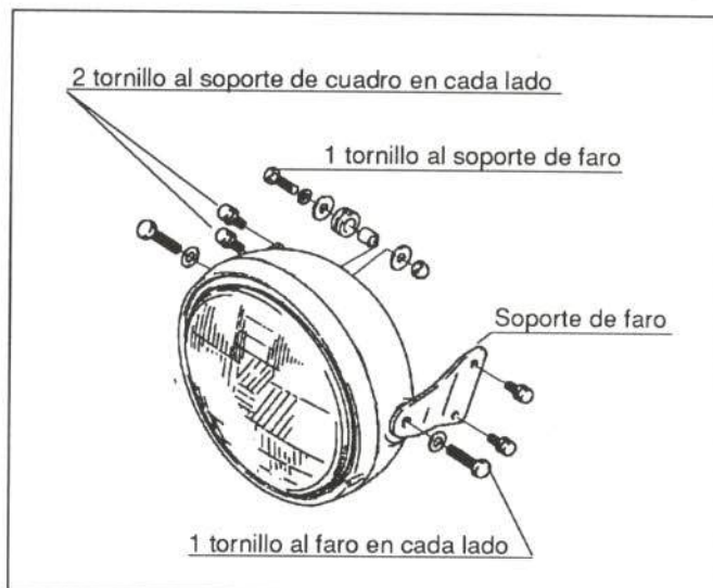
Figura 25.- Sujeción del faro
